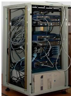
Rack de routing / switching cu server de stand, replicator de porturi și configurare de la distanță
